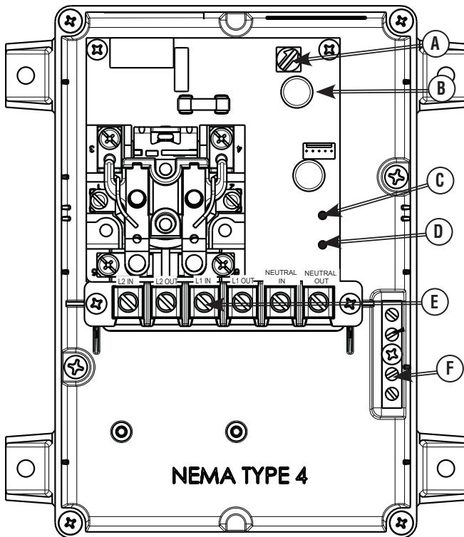
Si un ou plusieurs appareils de 120 V c.a. sont connectés au module à distance de 50 A, les bornes « L1 IN » et « L1 OUT » doivent alors être utilisées. Les charges multiples connectées doivent être ajoutées/délestées en même temps.
